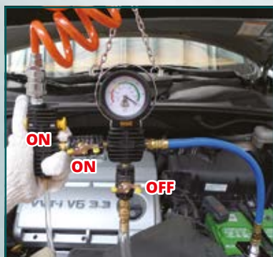
Fig. 3 CREËER EEN VACUÛM IN HET KOELSYSTEEM | Abb. 3 EIN VAKUUM IM KÜHLSYSTEM HERSTELLEN
