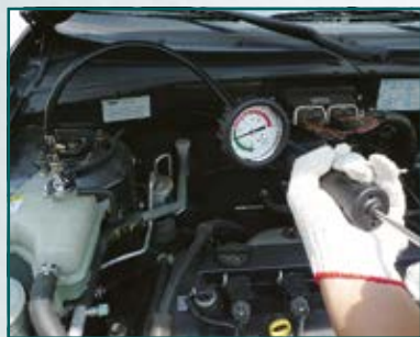
Fig. 2 LEKKAGETEST VOOR DE RADIATORKLEP | Abb. 2 DICHTHEIT-TEST FÜR KÜHLERDECKEL
