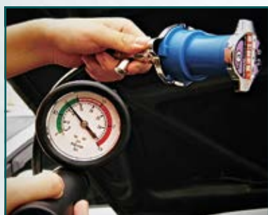
Fig. 2 LEKKAGETEST VOOR DE RADIATORKLEP | Abb. 2 DICHTHEIT-TEST FÜR KÜHLERDECKEL
